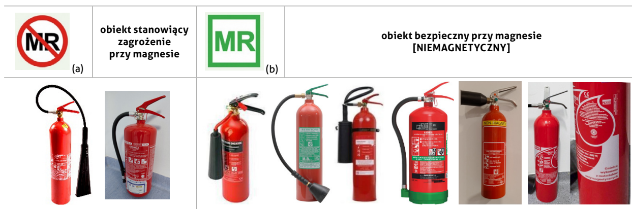
Ryc. 7. Przykładowy wygląd: (a) typowych gaśnic śniegowych, ferromagnetycznych stanowiących zagrożenie przy magnesie S-RM; (b) gaśnic śniegowych niemagnetycznych, bezpiecznych w pobliżu magnesu S-RM
